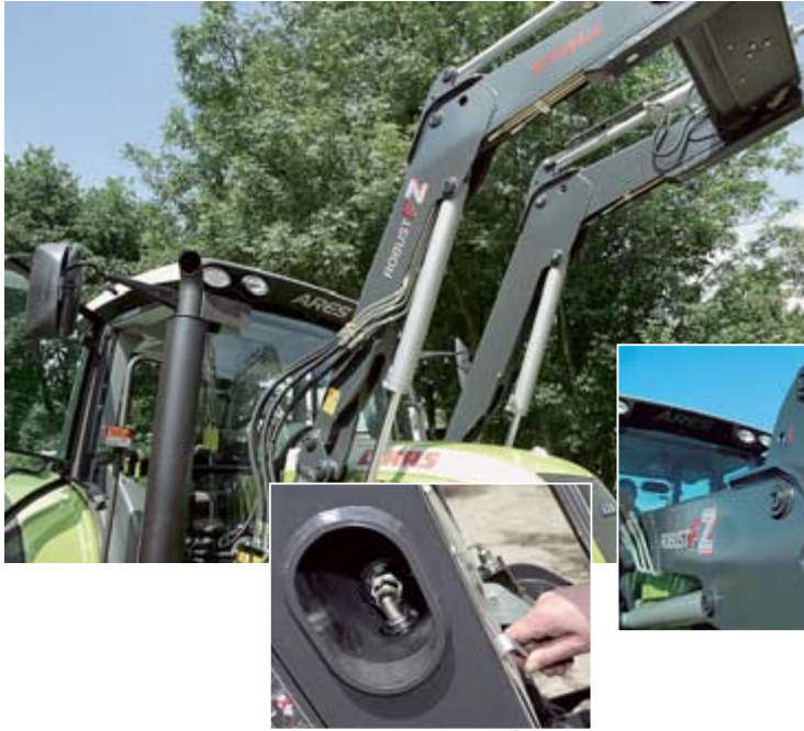
Drei Kennzeichen des Robust FZ: die Leitungen unter den Holmen (links), der Dämpfungszyylinder im Querholm (links unten) und die Z-Kinematik der Parallelführung (unten).
