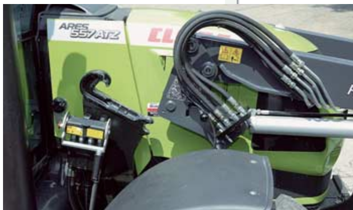
Dem Koppelsystem mit Fanghaken und Spannkeilverriegelung ist Stoll treu geblieben.
